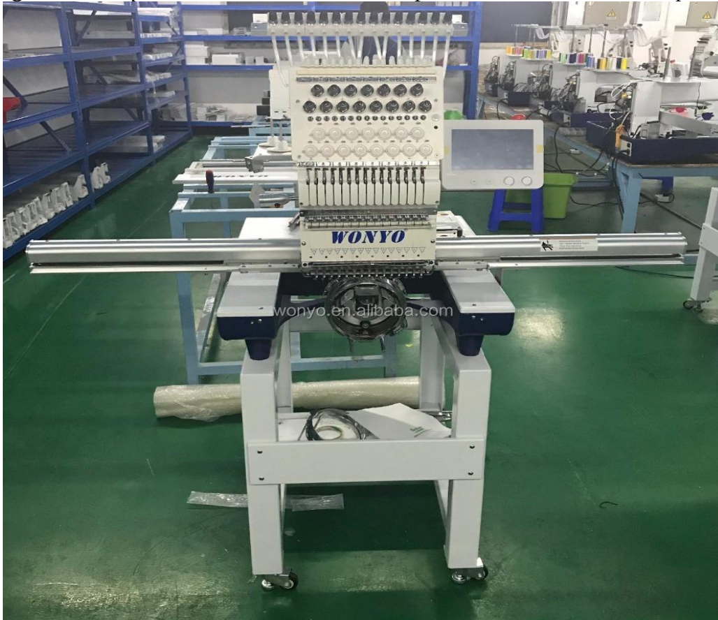
Figura 2. Maquina bordadora de una cabeza para elaboración de diseños personalizados.
