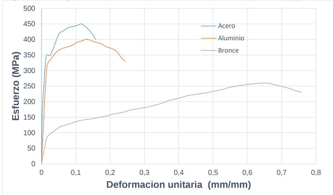
Figura 28. Diagrama Esfuerzo deformación de Acero 1020 Aluminio y Bronce
