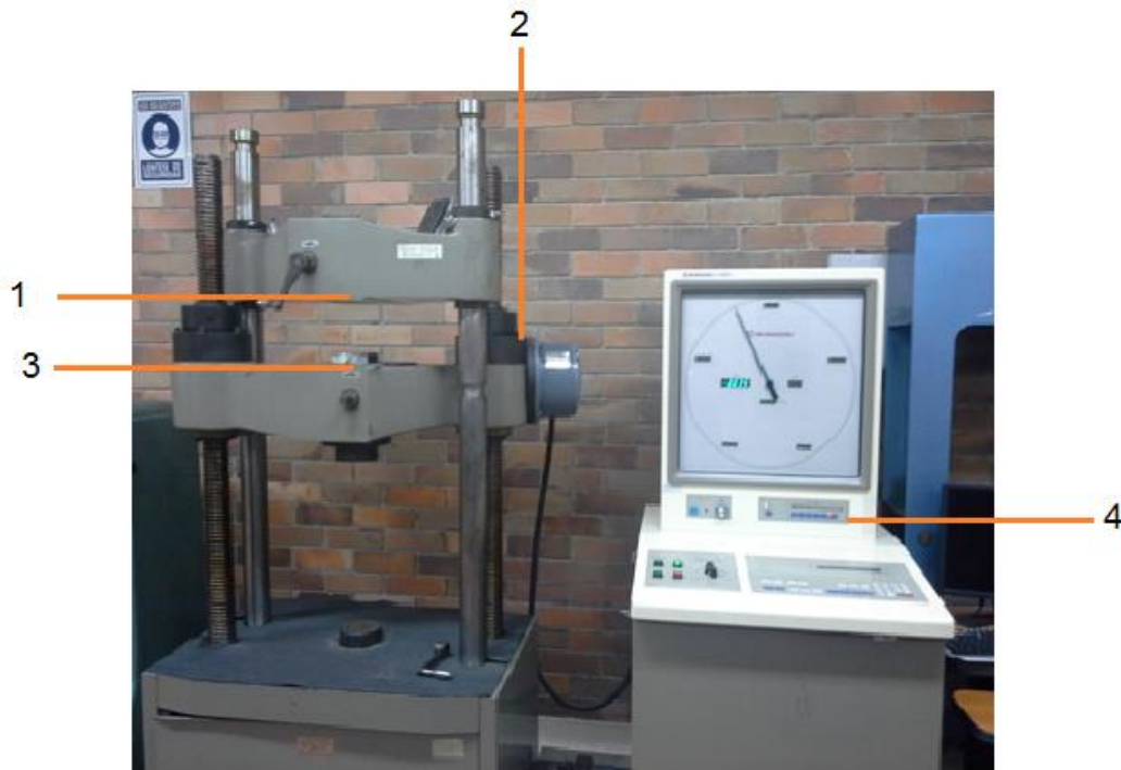
Figura 8. Máquina universal utilizada en el ensayo de tensión
