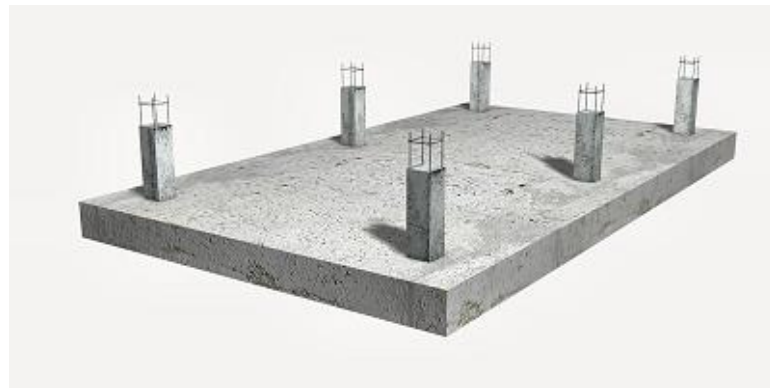
Ilustración 6.5. Losa de cimentación [8]
