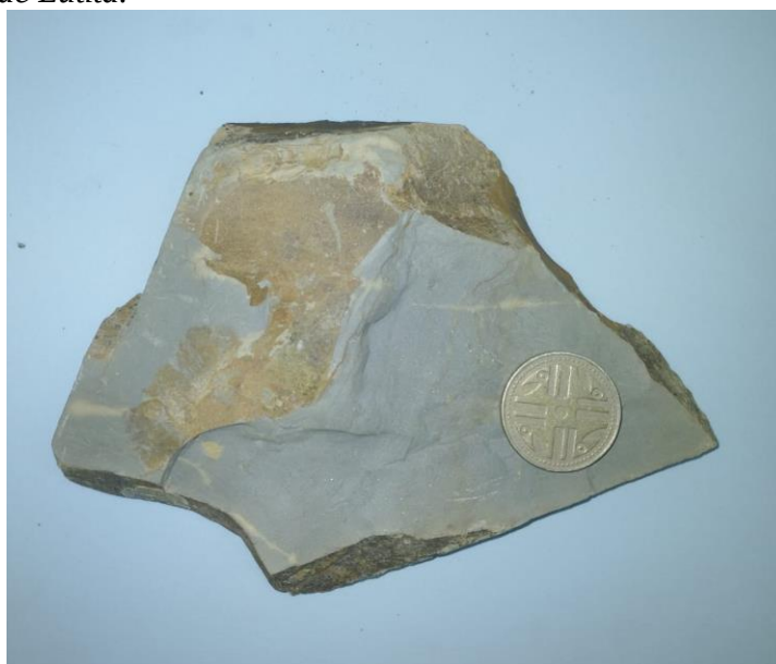
Figura 6. Muestra de Lutita.
