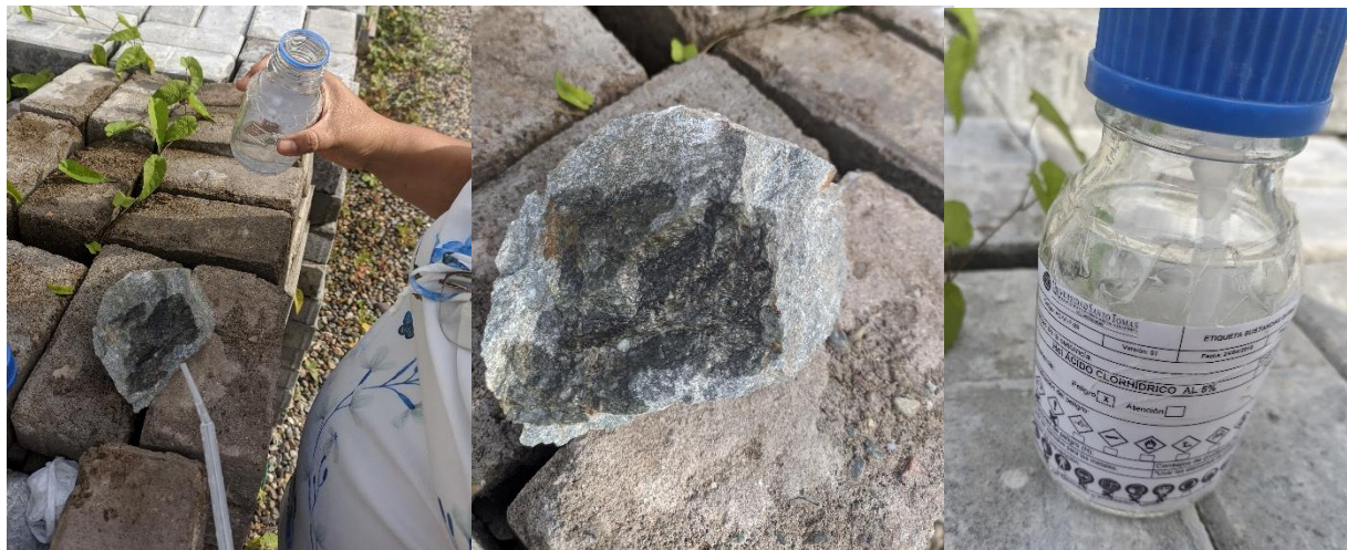
Figura 22. Resultado de la prueba de efervescencia
