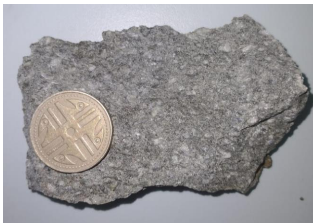
Figura 8. Muestra de Roca Pórfido Dacítico.
