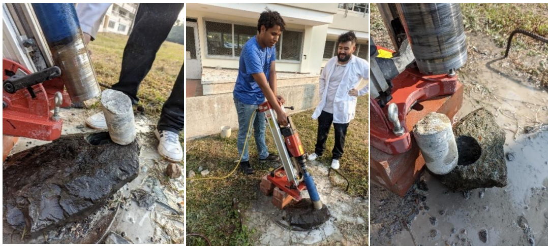
Figura 19. Extracción de núcleos a las Rocas
