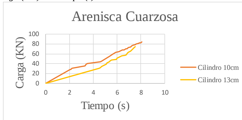
Figura 23. Carga (KN) Vs Tiempo (s). Muestra Arenisca Cuarzosa
