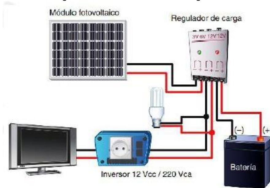
Figura 15 Plano sistema de energía solar
