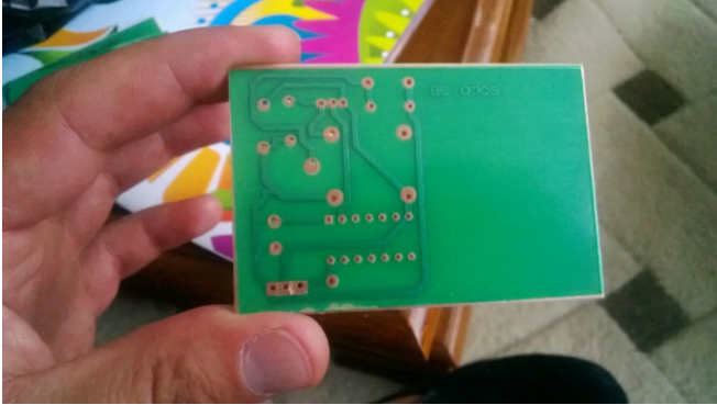
Figura 97. Circuito impreso trasero.
