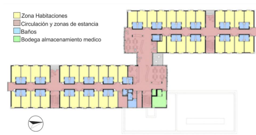
Figura 26. Planta tercer nivel
