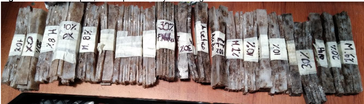
Figura 13 Probetas tipo I, matriz polimérica y fibra de guadua
