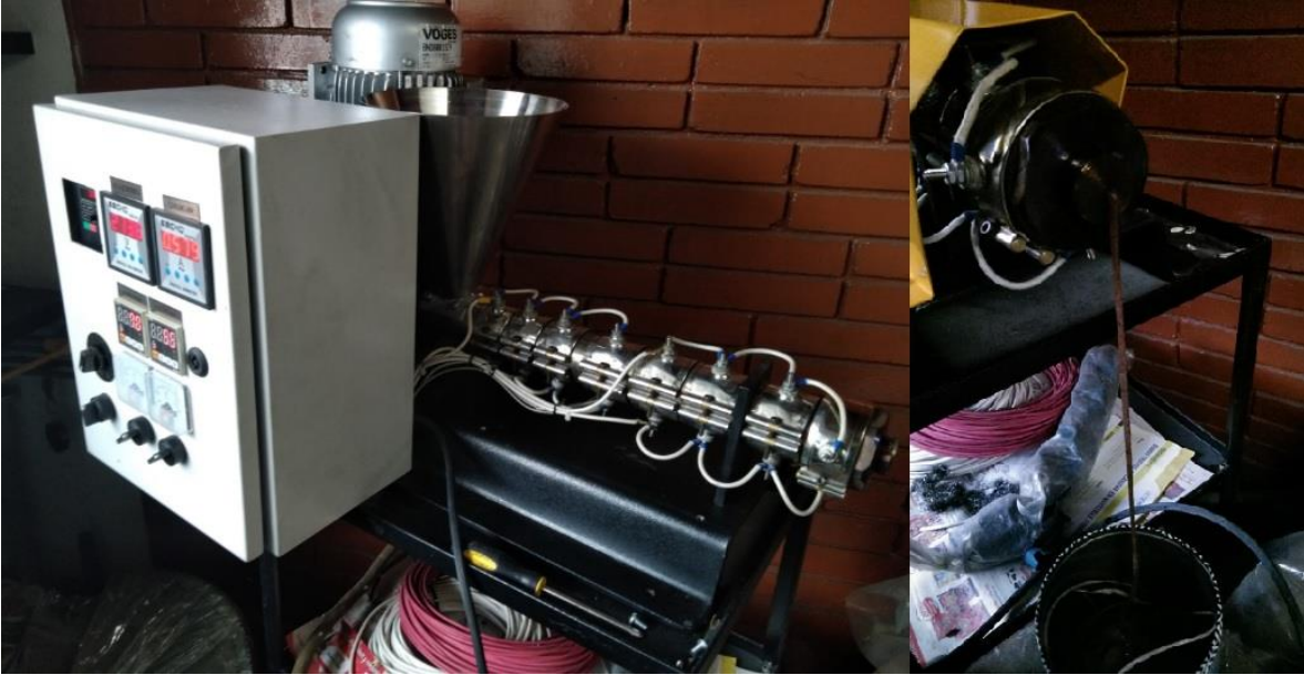
Figura 10 Extrusión fibra de guadua más LDPE
