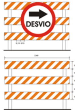
Ilustración 9 (Señal reglamentaria + barricada - Señal de desvío, Fuente: Manual de señalización vial).
