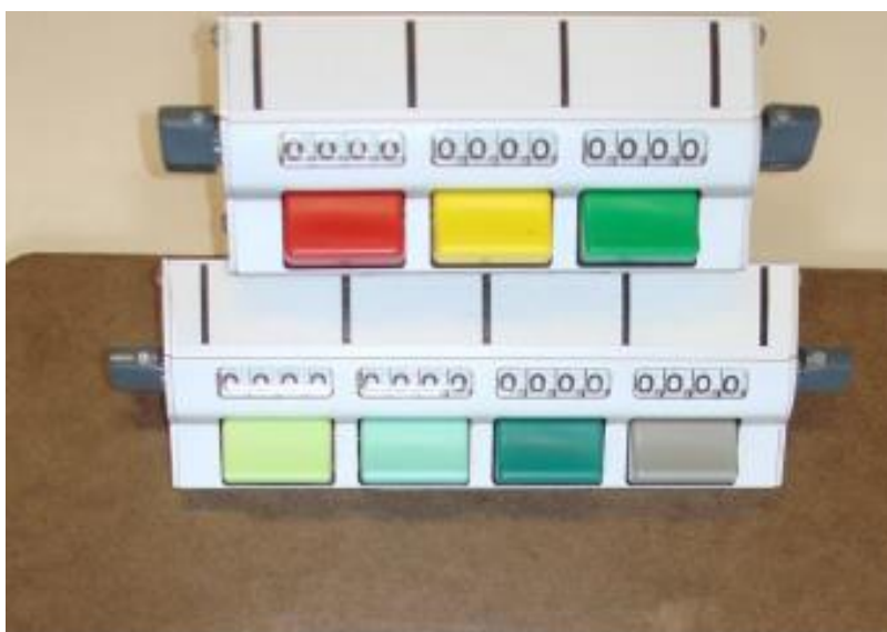
Figura 5 Contador Mecánico Manual -SOPARC-
