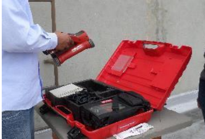
Ilustración 22. Ferroskan Hilti PS200 usado en la prueba. Fuente: Consorcio Sedic-Concol 023
