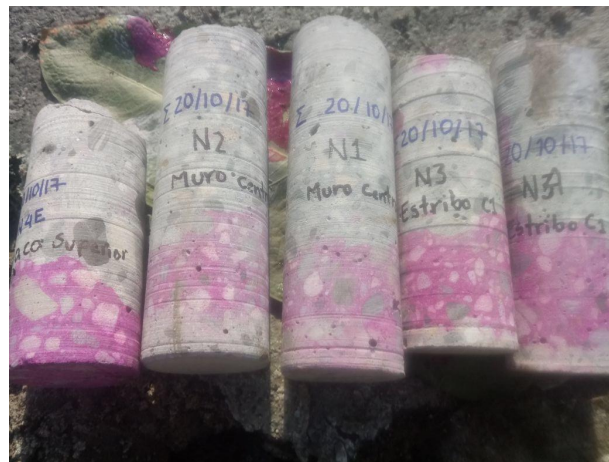
Ilustración 23. Prueba de carbonatación.
