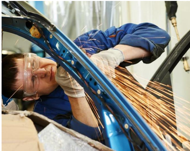
Figura 34. Uso de equipos de protección
