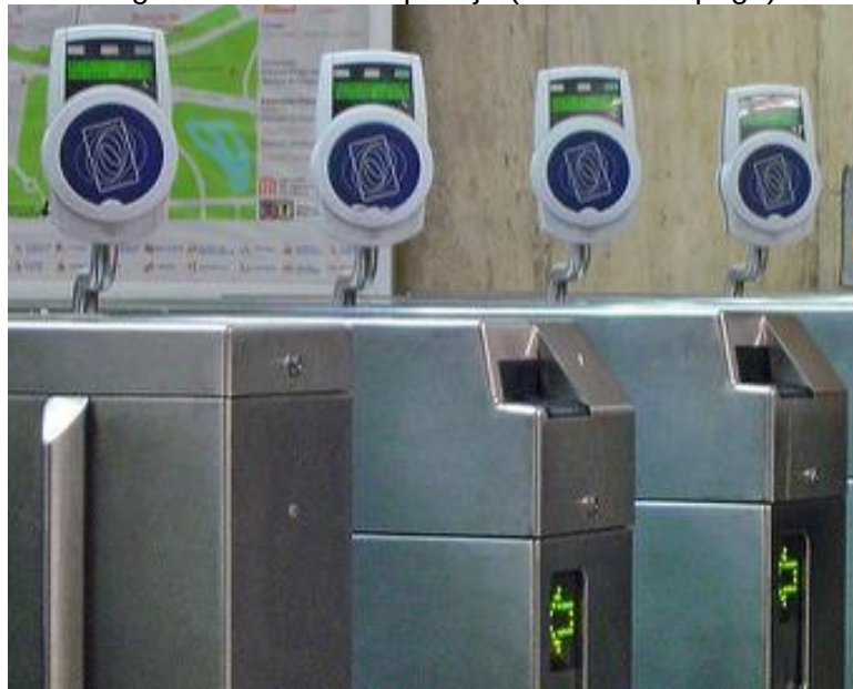
Figura 72. Sistema inteligente de cobro de pasaje (alcancía de pago).
