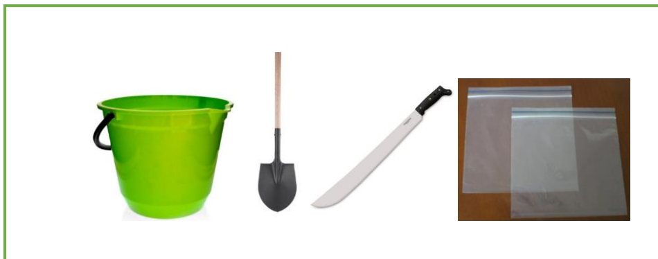
Figura 2. Materiales para realizar una muestra de suelo, Adaptado de: (Google, 2019)
