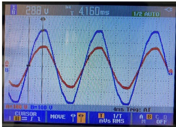
Ilustración 10.2. Resultado transformador monofásico (entrada de 156 V pico a pico y salida 288 V pico a pico), montaje experimental.
