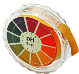
Figura 12: papel tornasol, para medir pH, tomado de; (Laboratorio Químico, 2009)
