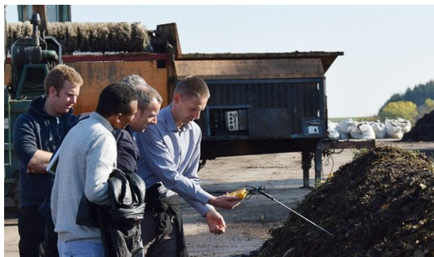
Figura 9: Medición de la temperatura con una varilla metálica, tomado de; (Andrade, 2014)
