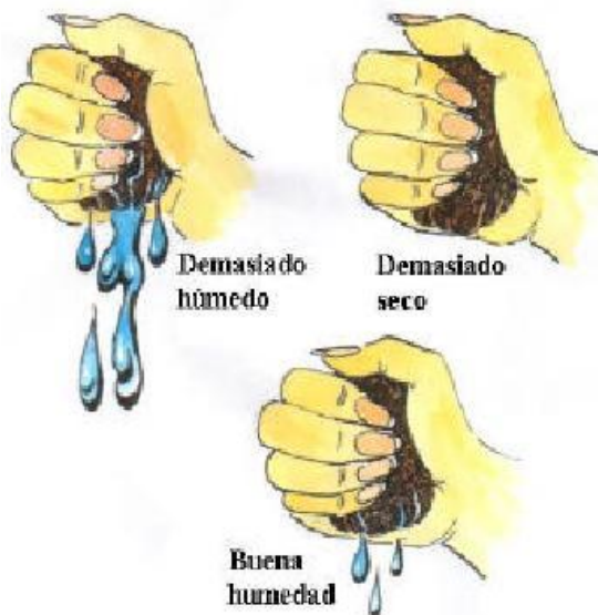
Figura 6: se muestra una manera sencilla de medir la humedad, tomado de; (López, 2009).
