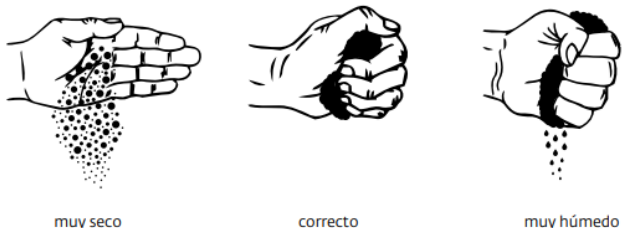
Figura 10: Prueba de puño, para medir humedad, tomado de; (Santana, 2019)
