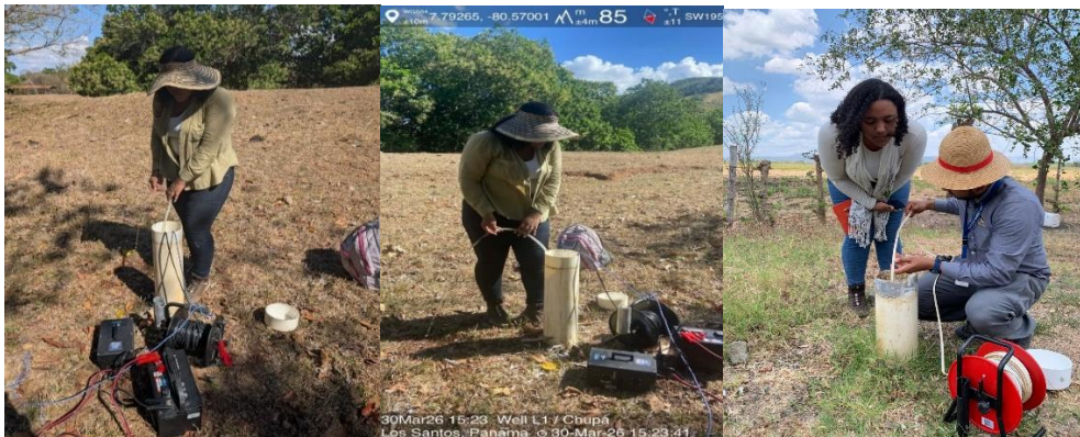
Fotografía 3. Medición manual de niveles piezométricos.
