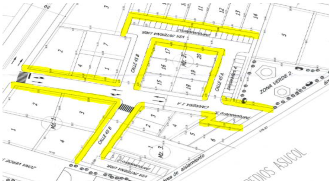
Figura 18. Plano de andenes y sardineles construidos.
