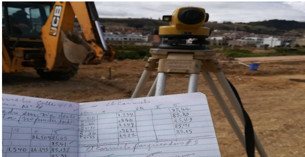
Fotografía 3. Nivelación topográfica datos de cartera
