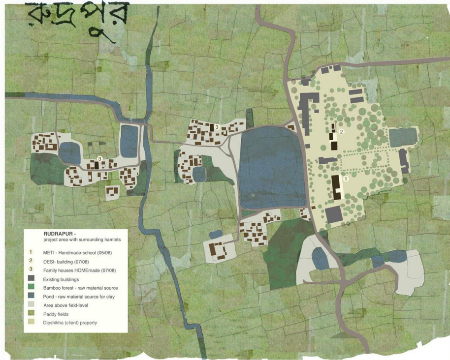
Figura 22. Planta general y ubicación de lugares de extracción de los materiales de escuela METI
