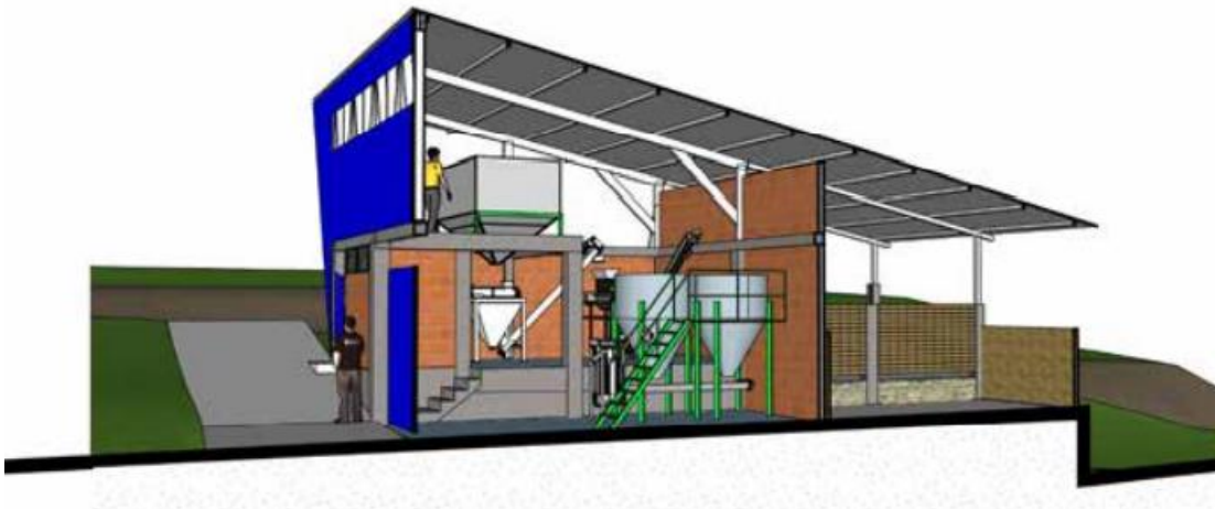
Figura 13. Corte general con vista de la maquinaria del beneficiadero ecológico comunitario de La Sierra.
