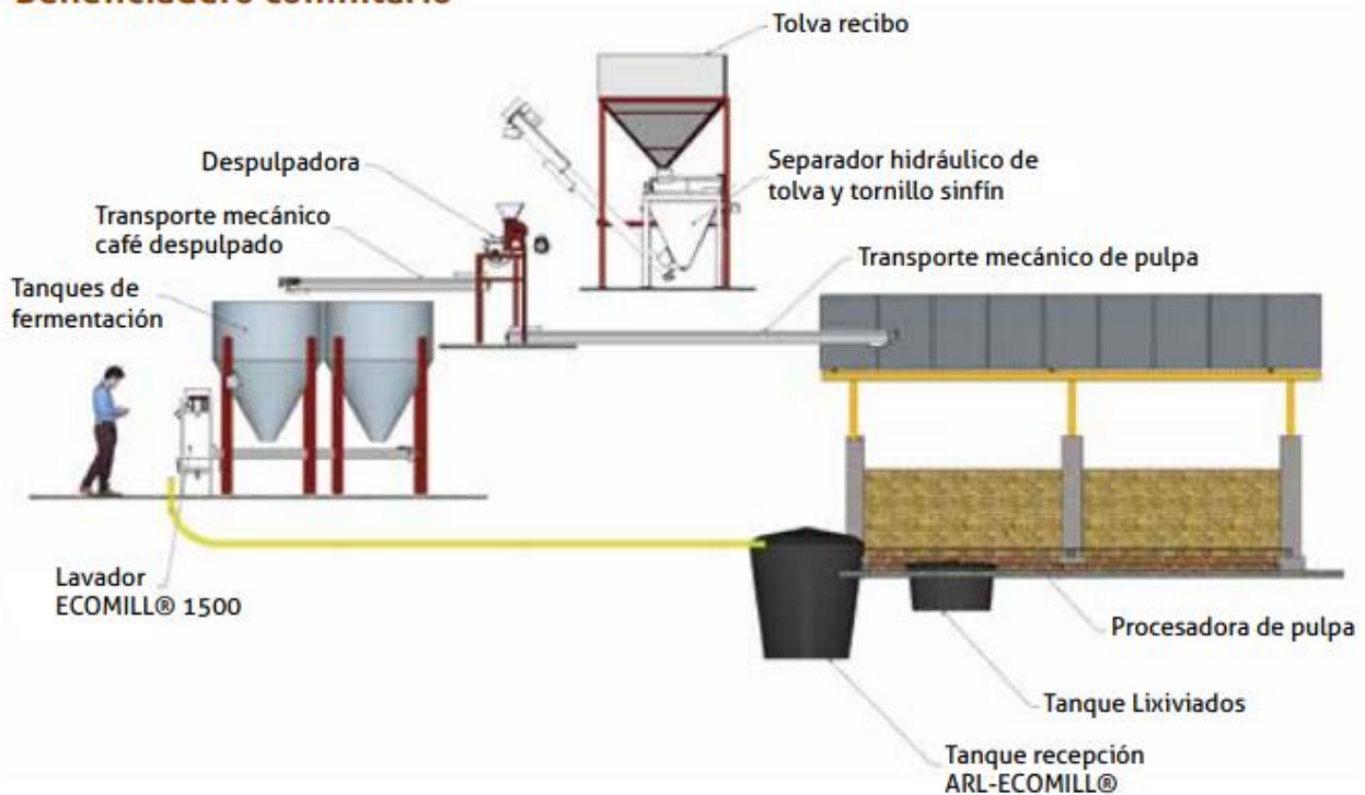
Figura 9. Esquema general de la configuración de equipos para los beneficiaderos comunitarios. Beneficiadero comunitario
