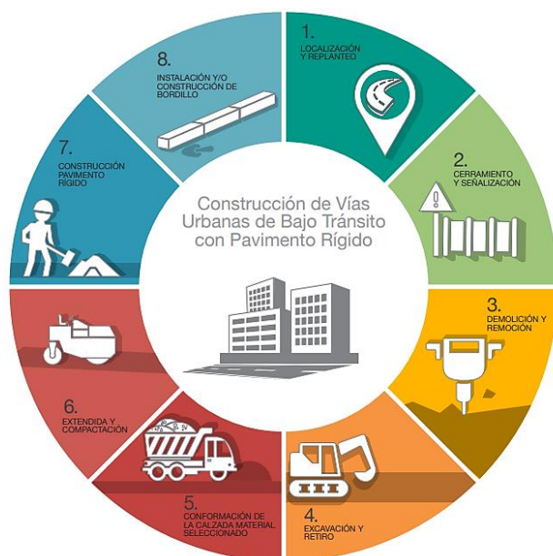
Figura 47. Construcción de vías urbanas de bajo tránsito con pavimento rígido
