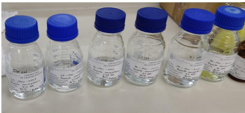
Figura 24. Estándares de calibración para la determinación de fósforo soluble
