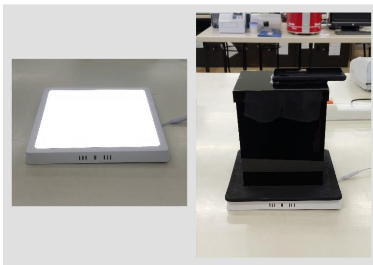
Figura 20. Vista lateral del lector colorimétrico alternativo
