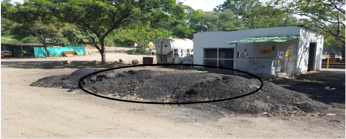
Figura 30. Derrame en cargue de producto final
