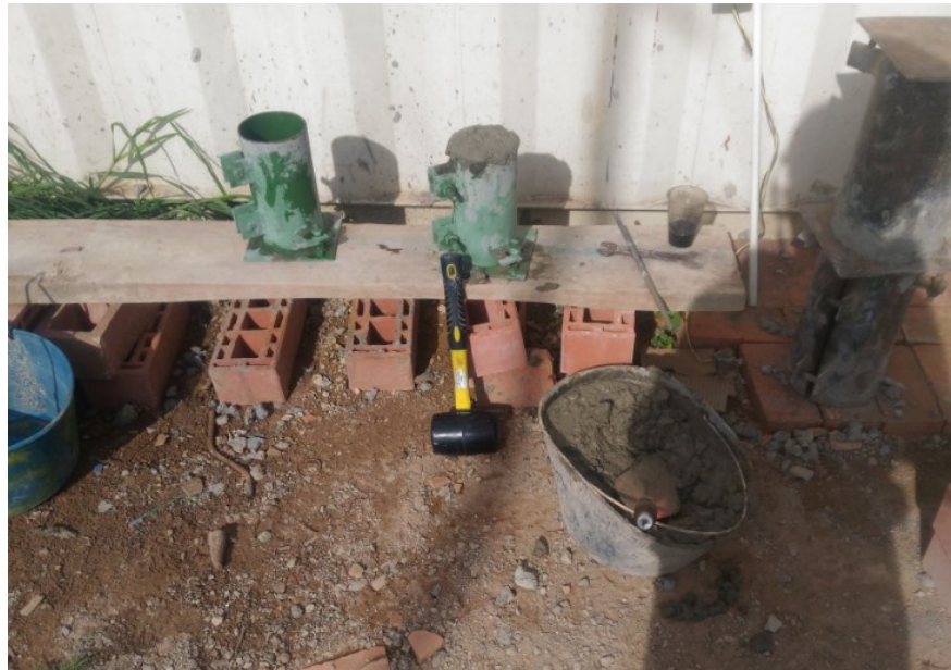
Se realizaron muestras de cilindros, resistencia esperada 2000psi
