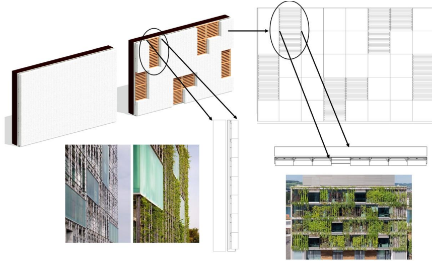
Figura 46 Detalle de sistema de fachada verde
