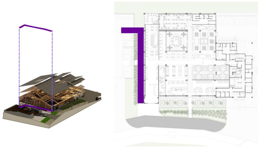
Figura 28. Punto fijo del proyecto
