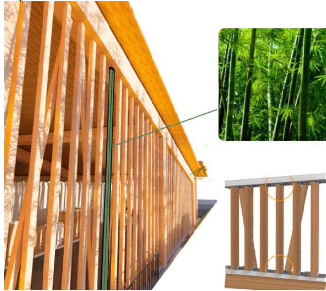
Figura 33. Materialidad de fachada en celosía de bambú
