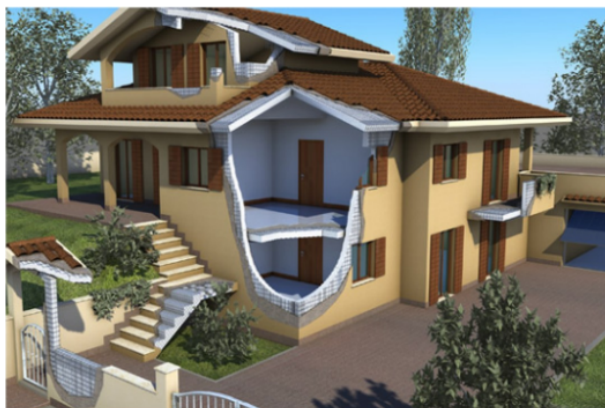
Ilustración 2 Sistema constructivo Durapanel
