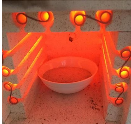
Ilustración 5 calcinación de la zeolita a 500 ° C
