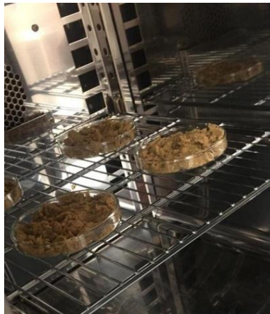
Ilustración 6 Clinoptilolita ácida en el horno con aireación a 120°C
