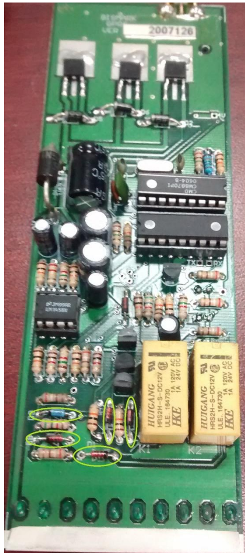
Imagen 12. Diodos en los que se debe revisar continuidad
