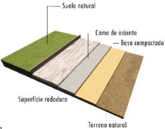
Detalle Materialidad Contra piso
