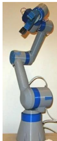
Figura 9. Modelo WE-R 2.4 (Robot de seis grados de libertad) fabricado a partir de impresión 3D [19].
