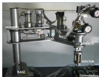
Figura 7. Arquitectura de robot Scara usado por la UPS para implementar sistema de control [18].
