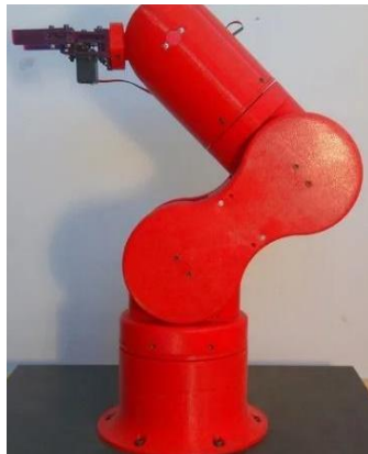
Figura 8. Modelo Thor (Robot de seis grados de libertad) manufacturado a partir de impresión 3D [19].
