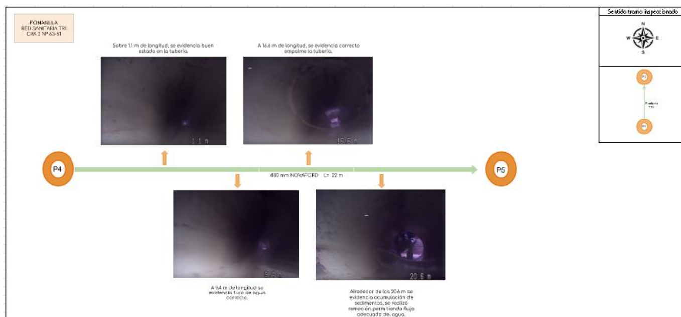
Ilustración 54. Informe inspección con cámara Fonanlla pozo 4 a 5
