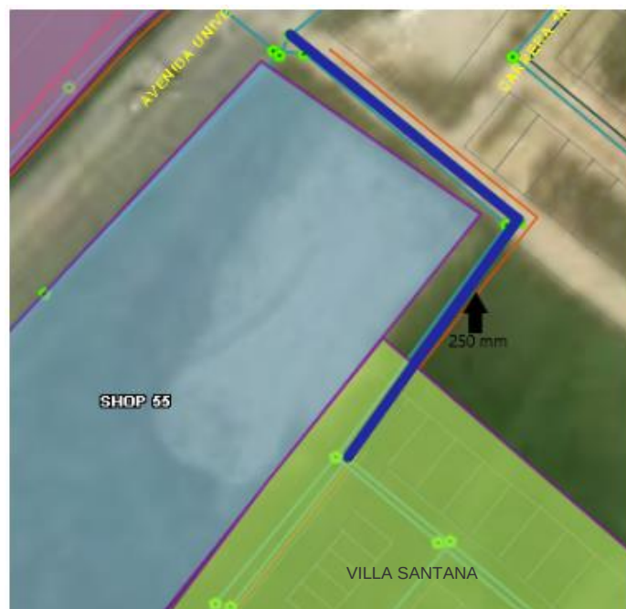
Ilustración 31. Plano 2 Villa Santa ficha catastral alcantarillado sanitario
