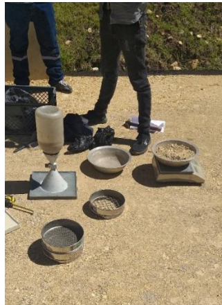
Figura 37. Materiales para prueba de densidades en terreno
