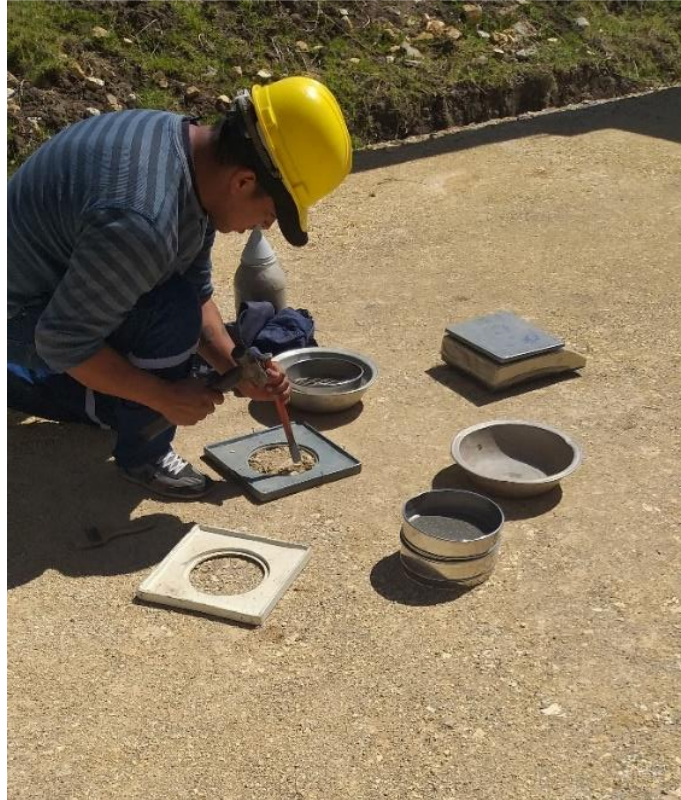
Figura 38. Obtención de muestras para la prueba de densidades
