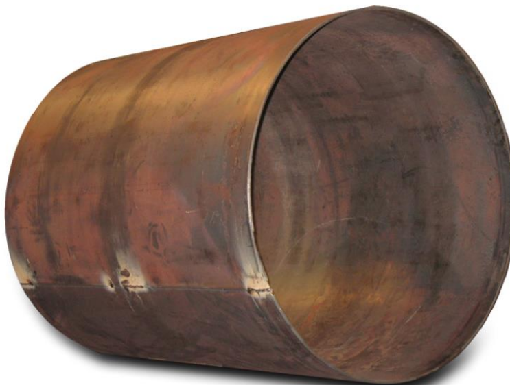
Imagen 3. Cilindro terminado, proceso de rolado de lamina
