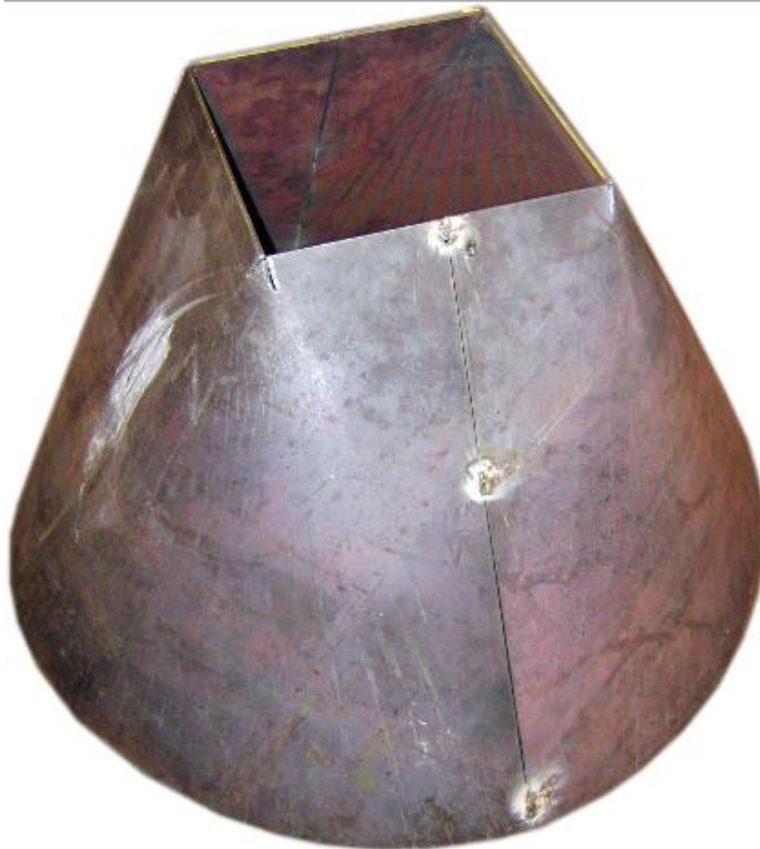
Imagen 5. Transición en acero, proceso de corte CNC y doblado de lámina
