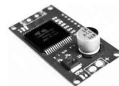
Figura 6. Driver Mini Moto Monster. La imagen fue adaptada de [6], Copyright © 2021 Robótica colombiana S.A.S. una empresa colombiana- tdrobotica.co™
