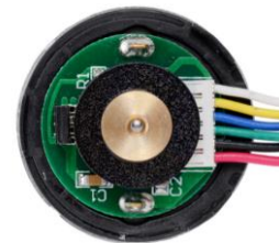
Figura 5. Encoder de cuadratura con 64 CPR. La imagen fue adaptada de [5], Copyright © 2001–2021 Pololu Corporation
