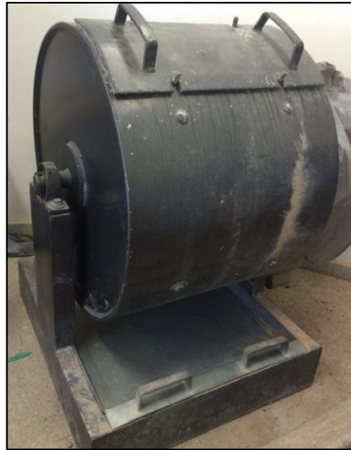
Figura 3-2. Máquina de Los Ángeles. Fuente: Rondón y Reyes (2015).
