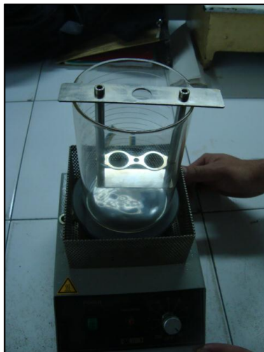
Figura 3-5 Aparato de anillo y bola. Fuente Ruiz (2018)
