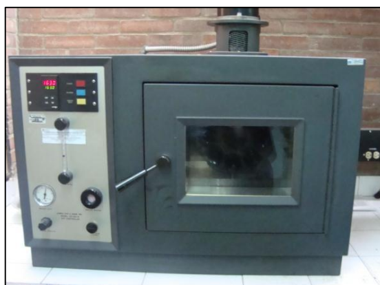
Figura 3-9 Horno RTFOT. Fuente: Rondón y Reyes (2015).
