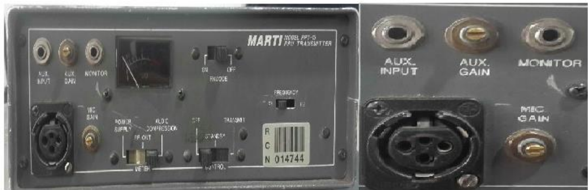
Figura 24. A la derecha panel frontal del RPT 245, a la izquierda entradas de audio del RPT 245, con los respectivos controles de ganancia.
