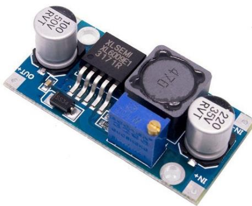
Figura 35: Modulo convertidor DC-DC Boost XL6009 [41]
