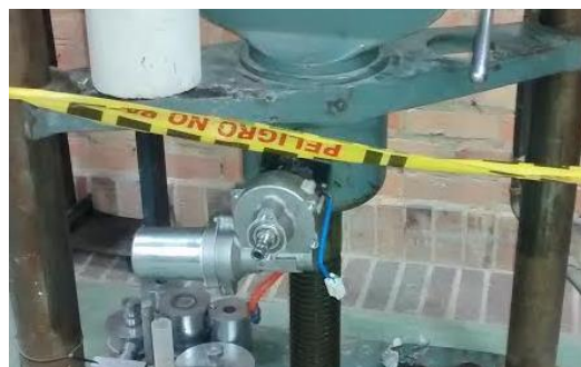
Figura 57 moto reductor instalado Tomado de: AUTOR
