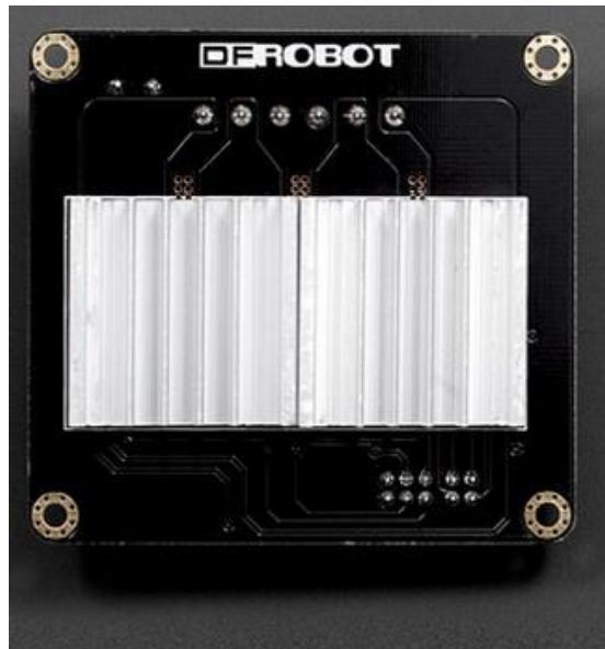
Figura 60 Disipador de calor driver parte posterior.
