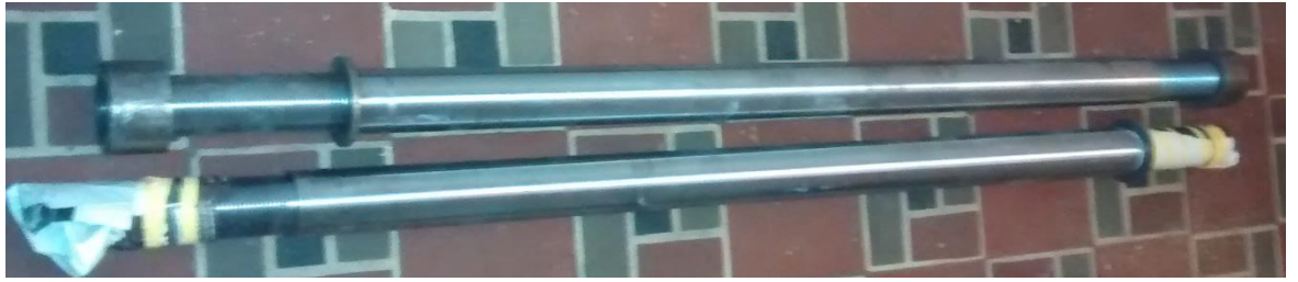
Figura 32 Barras de acero macizo nuevas con maquinado y roscado. Tomado de: AUTOR
