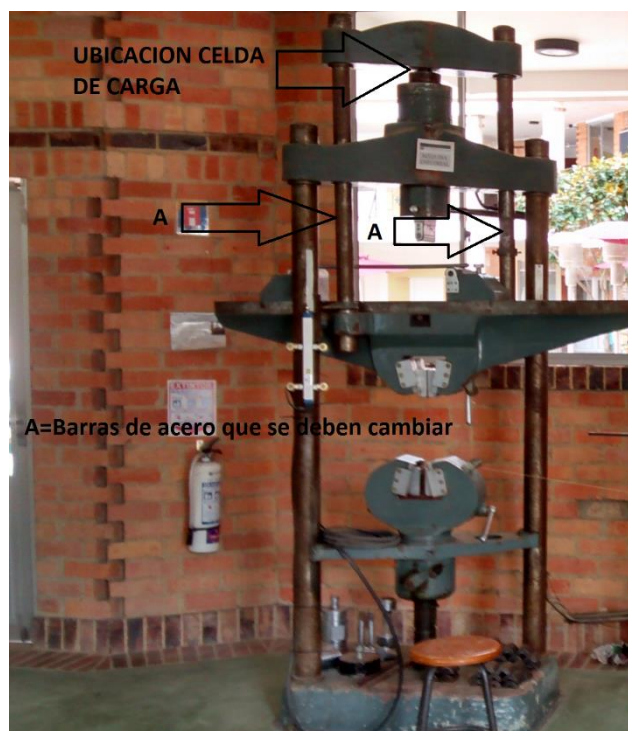
Figura 31 Ubicación celda de carga y barras de acero. Tomado de: AUTOR
