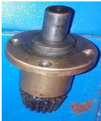
Figura 54 Eje manivela mandíbula superior Tomado de: AUTO
