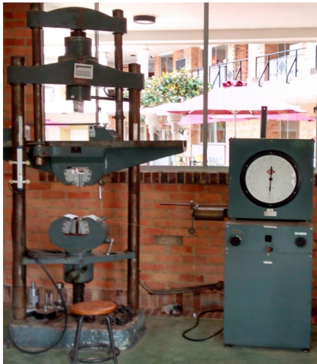
Figura 18 Consola de control maquina universal Tomado de: Autor
