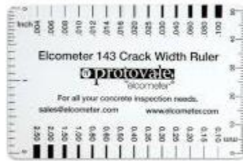
Figura 8 Fisurómetro Fuente: Propia
