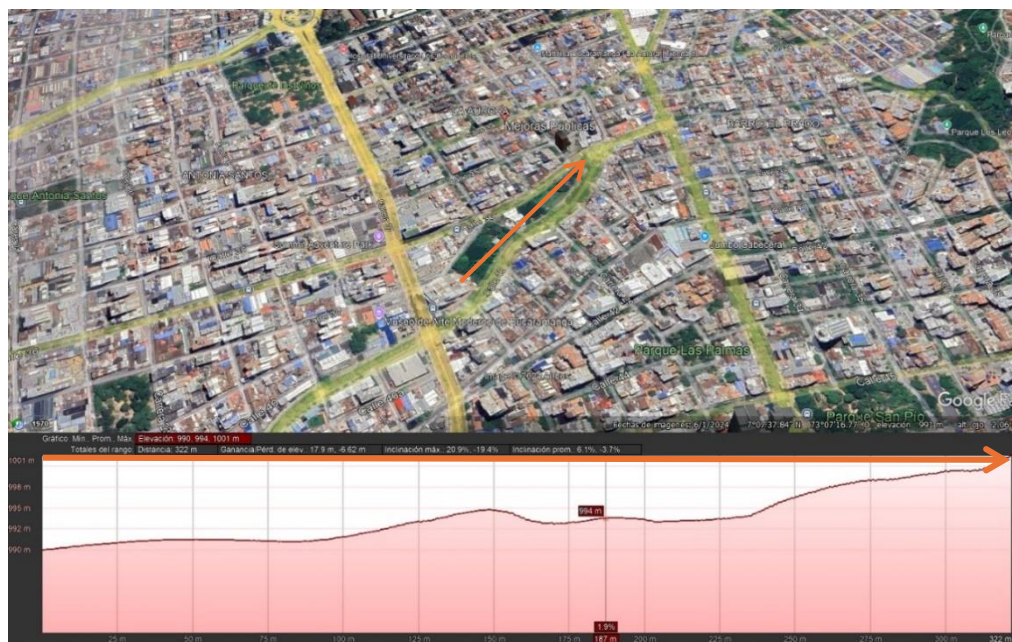
Figura 19. Sección topográfica Longitudinal.
