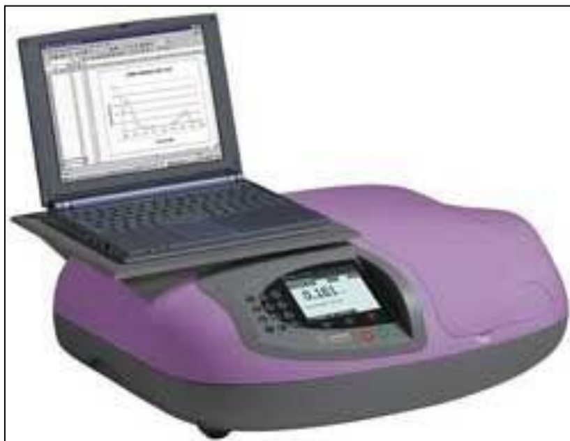
Ilustración 4. Equipo GE Ultropsec 2100 Pro Spec UV Vis para la detección y determinación de Cr(VI) en las muestras de agua.
