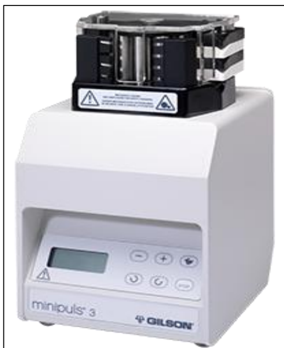
Ilustración 5. Bomba peristáltica utilizada para el transporte de líquidos (soluciones y muestra).
