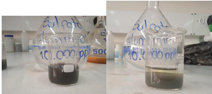
Imagen No. 10 y 11: Segunda muestra de agua no tratada con 0,3 ml de Sulfato de Aluminio.
