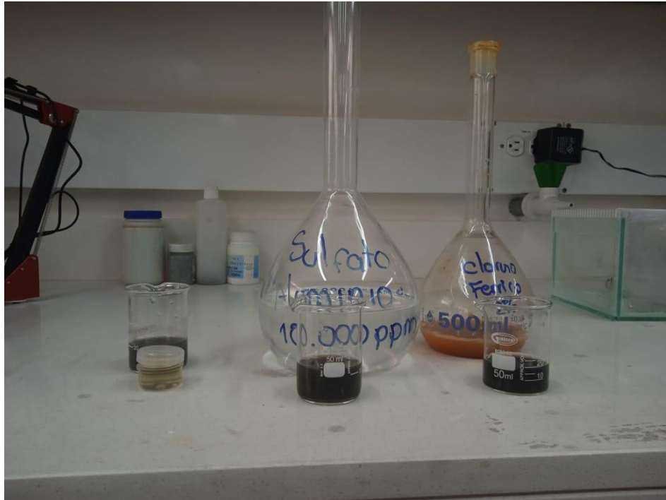
Imagen No. 7: Ensayo de laboratorio con tres coagulantes distintos.
