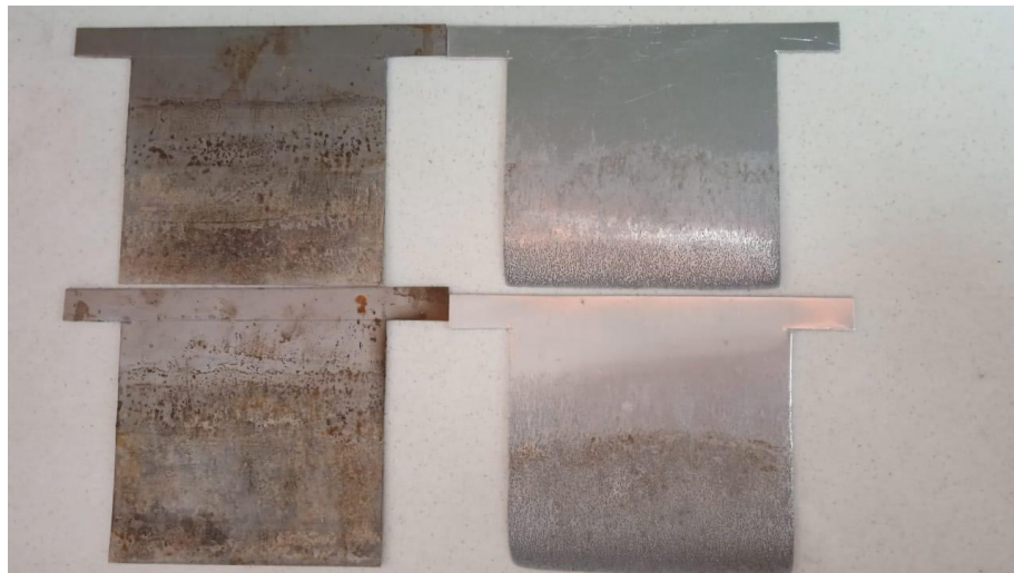
Imagen No. 19 & 20: electrodos en la fase final y comparación del agua sin tratar con el agua tratada finalmente.
