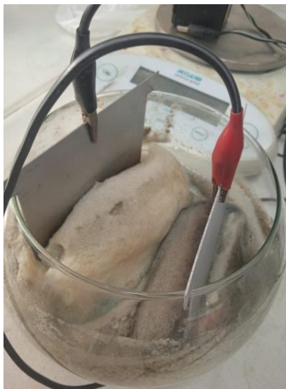
Imagen No. 6: Ensayo de laboratorio con un electrodo de aluminio y otro de hierro.
