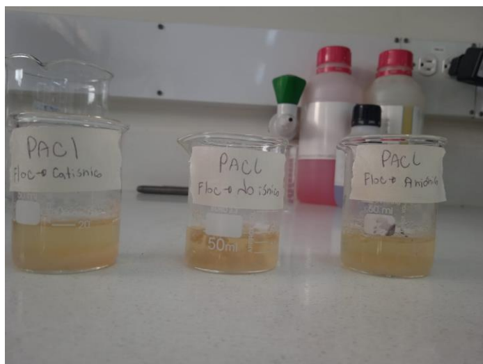
Imagen No. 16: Muestras de agua residual industrial tratada con electrocoagulación, con distintos floculantes.
