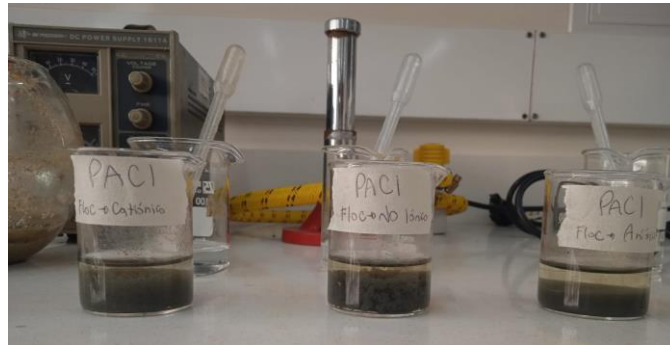
Imagen No. 14: Pruebas de floculantes en 20 ml de muestra de agua residual industrial sin tratar.
