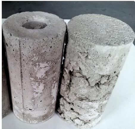
Figura 27. Fallos generados durante el proceso de ejecución de una mampostería confinada (personal no cualificado para realización de pruebas)
