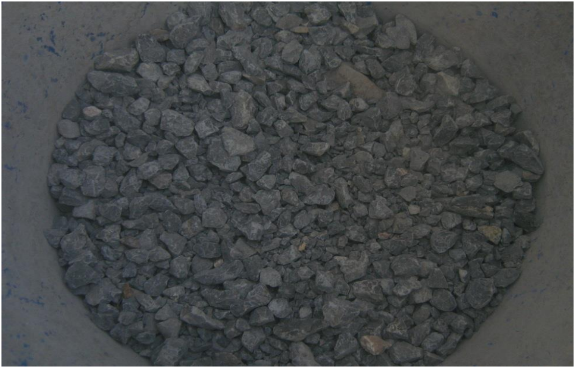
Muestra de grava dentro del filtro
