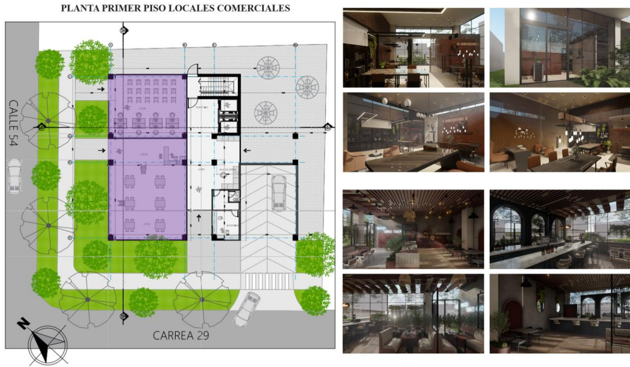
Figura 57. Planta primer piso locales comerciales
