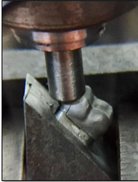
Figura 18. Fisura de la corona Fuente Juliana Aranzazu R. – Leidy Ávila D.
