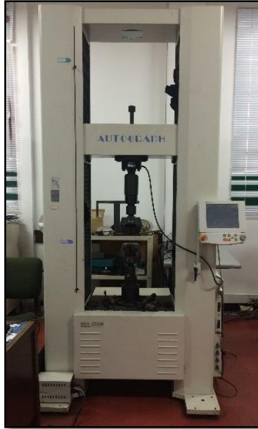
Figura 34. Máquina de prueba universal AG-I 250 SHIMADZU Fuente: Universidad Santo Tomas Bucaramanga (Mecatrónica)
