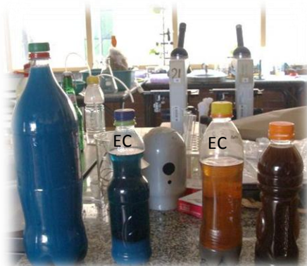
Figura 21. Aguas residuales por tinta antes y después de la electrocoagulación.
