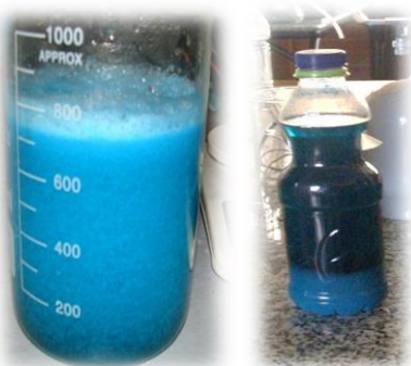
Figura 20. Flóculos formados y sedimentación de los mismos.
