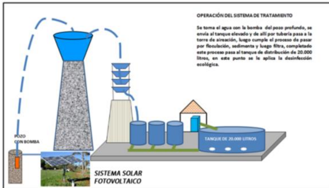
Gráfica 3. Bombeo de agua con energía solar fotovoltaica
