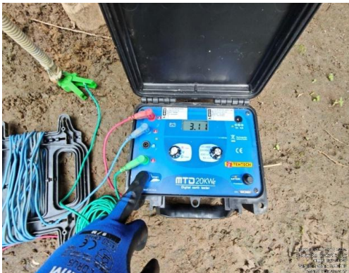
Imagen 7. Telurómetro para medición de sistema de puesta a tierra
