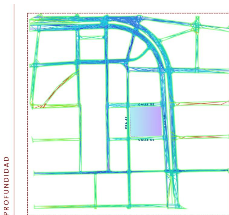
76 Imagen. Diagrama de profundidad espacial basado en la metodología Space Syntax. Fuente: (Elaboración propia)
